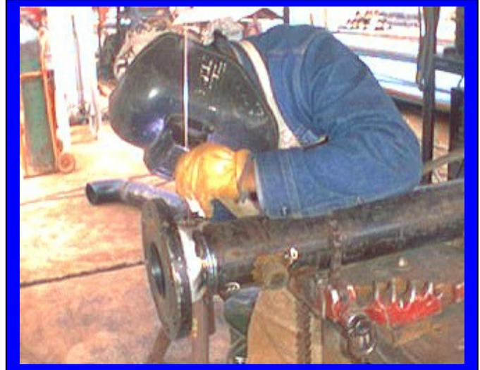
Este proceso es llamado **TIG** ya que intervienen un electrodo no consumible de Tungsteno y un Gas Inerte de Protección que en ingles se lee: ( Tungsten Inert Gas ). El proceso de soldadura TIG se puede realizar con o sin material de aportación.
